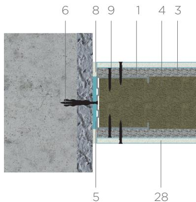
**Т-образное соединение перегородок с обшивкой ФП+ГКЛ**
