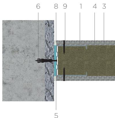
T-образное соединение перегородок с однослойной обшивкой
