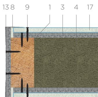
**Устройство перегородки с обшивкой (ФП+ГКЛ) по деревянному каркасу**
