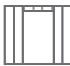
Каркас с дверным проемом
