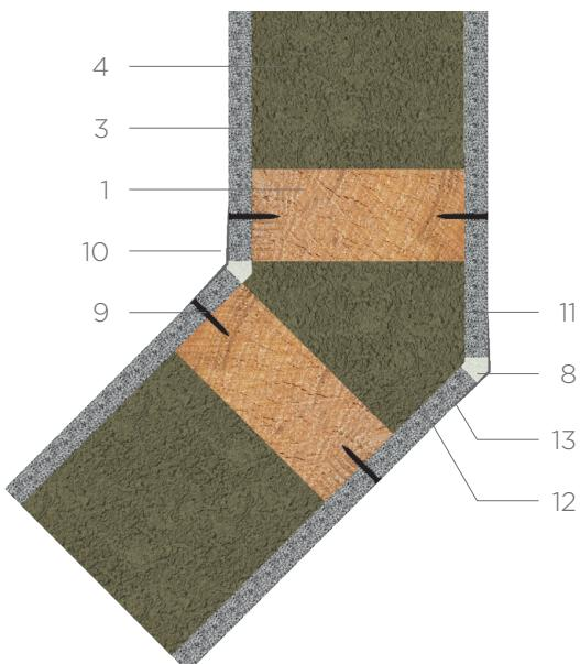
**Узел соединения перегородки и наружной кирпичной стены**
