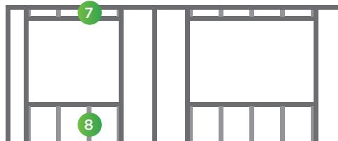
Каркас с двумя оконными проемами
