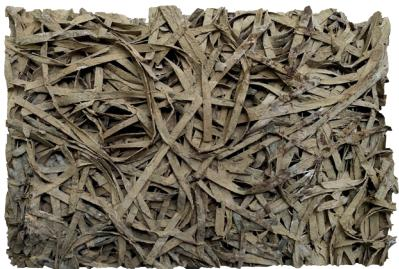
фибролитовая плита 1960 года производства
