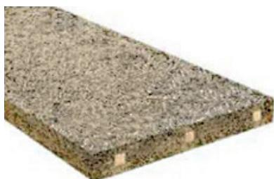
Применяются усиленные плиты, армированные деревянными рейками. Плиты не только являются конструкционным элементом, выдерживающим снеговую нагрузку, но и выполняют роль утеплителя и звукоизолятора при толщине 100 мм. Повышенные показатели огнестойкости материала дают возможность кровельщикам наплавлять рулонные материалы на плиту с помощью открытого огня.
