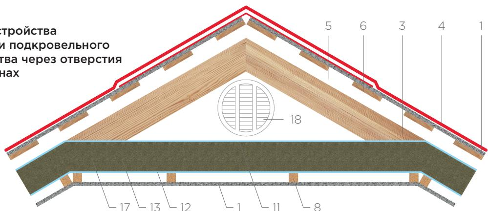
**Узел устройства скатной крыши по металлическим стропилам**
