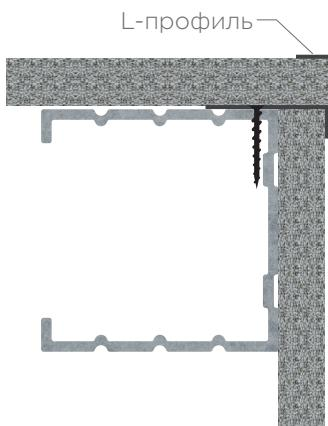
Если в качестве плинтуса используется L-профиль, то панель предварительно вставляется в технологический паз L-профиля и далее уже крепится к каркасу с помощью омега-профиля.
