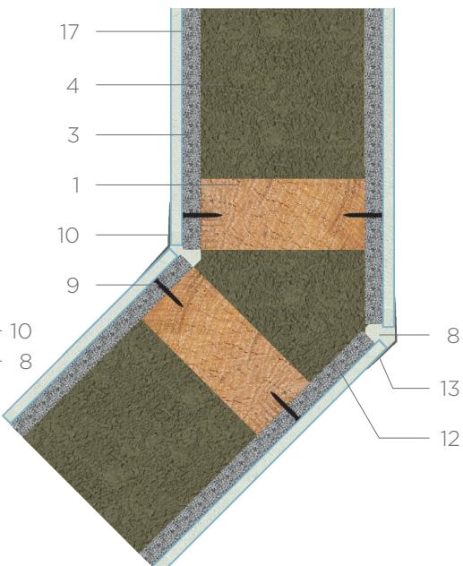
**Узел соединения перегородки (обшивка ФП+ГКЛ) и наружной кирпичной стены**
