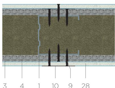
**Угловое соединение перегородок с обшивкой ФП+ГКЛ (угол > 90°)**
