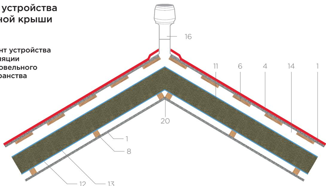
**Вариант устройства вентиляции подкровельного пространства через отверстия на фронтонах**
