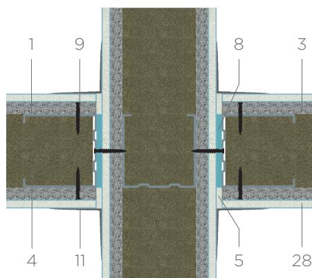
**Узел соединения перегородки с бетонным перекрытием**
