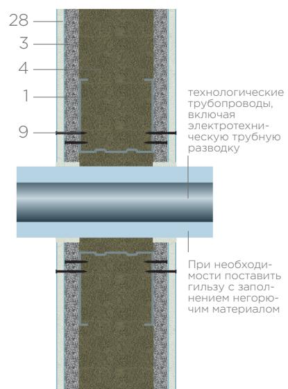
**Схема облицовки коммуникаций по вертикали (расположенных вдоль перегородки по горизонтали)**
