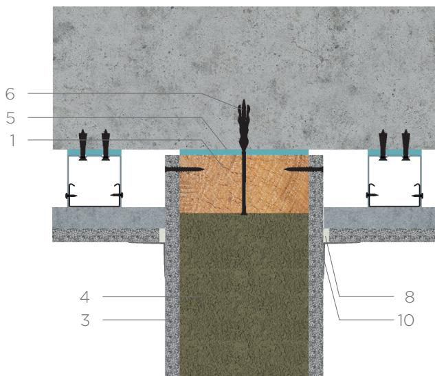
Узел соединения перегородки с бетонным перекрытием
