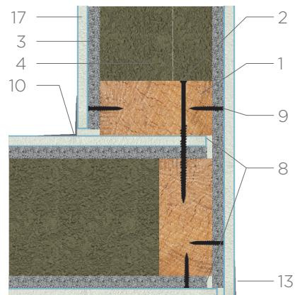
**Узел устройства дверного проёма**
