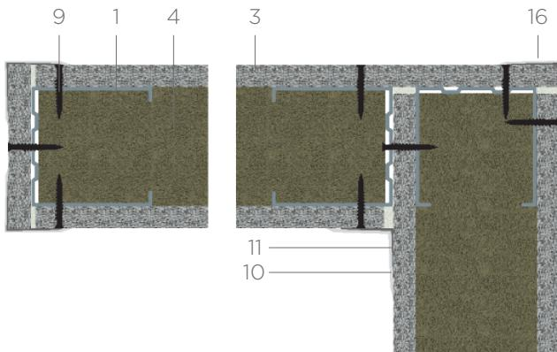
**Угловое соединение перегородок с однослойной обшивкой (угол = 90°)**
