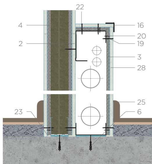
**Схема облицовки коммуникаций по горизонтали (расположенных вдоль перегородки по вертикали)**
