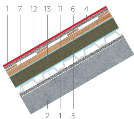
**Узел устройства скатной крыши по деревянным стропилам**
