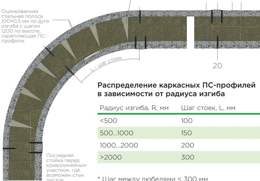
**Распределение каркасных ПС-профилей в зависимости от радиуса изгиба**
