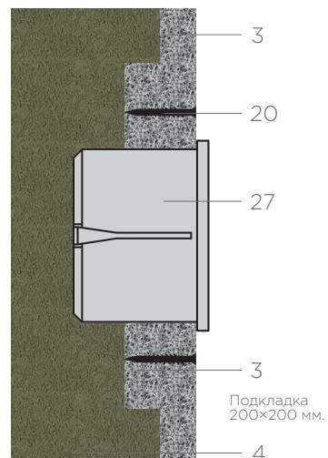
**Устройство перегородки с однослойной обшивкой по металлическому каркасу**
