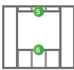
Каркас с оконным проемом
