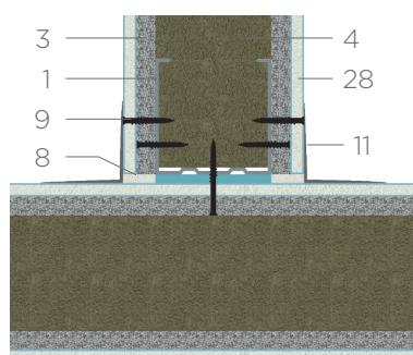
**Угловое соединение перегородок с обшивкой ФП+ГКЛ (угол = 90°)**
