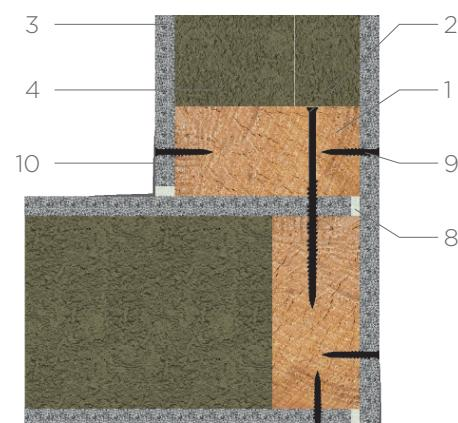
**Узел устройства дверного проёма**
