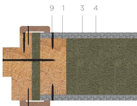
**T-образное соединение перегородок с однослойной обшивкой**
