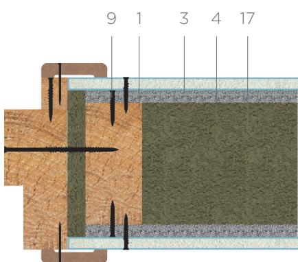
**Т-образное соединение перегородок с обшивкой (ФП+ГКЛ)**
