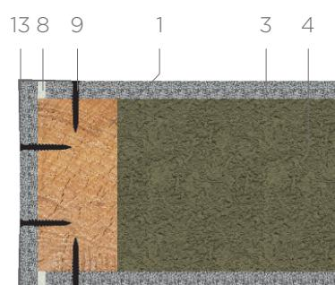
**Устройство перегородки с однослойной обшивкой по деревянному каркасу**
