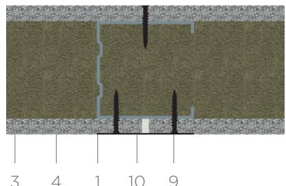
**Узел соединения перегородки с бетонным перекрытием**
