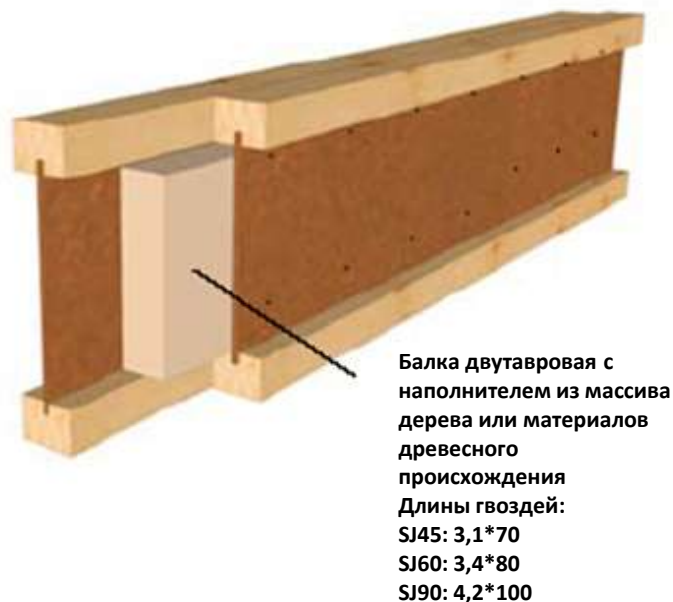
F15 Сдвоенная балка с древесным наполнителем
