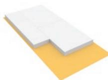
Укладка плит пенополистирола плотностью >25 кг/м<sup>3</sup>. Стыки плит проклеиваются монтажным клеем.
