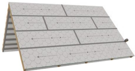
Места стыковки и торцы плит проклеиваются скотчем (рекомендуется водостойкая усиленная строительная клейкая лента).
