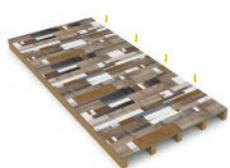
Укладка последующих плит выполняется со смещением, не допуская образования перекрестных швов. При монтаже плита обязательно должна покрывать не менее 3-х лаг. По завершению укладки плиты дополнительно крепятся саморезами по периметру.
