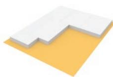
Укладка плит пенополистирола плотностью > 25 кг/м<sup>3</sup> на сухое и выровненное основание. Стыки плит проклеиваются монтажным клеем.
