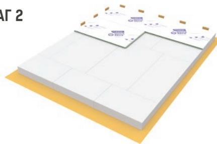
Укладка плит QUICK DECK на пенополистирол начинается от дальнего угла, противоположного входу. Между стеной и плитами необходимо оставлять зазор 5-10мм. Штыки плит не должны совпадать со штыками пенополистирола. Аналогично плитам утеплителя, плиты QUICK DECK укладываются со смещением, не допуская образования перекрестных швов.
