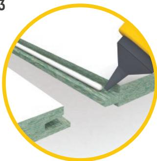
Стыки плит проклеиваются водостойким клеем ПВА D3 или D4.
