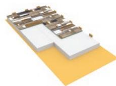
Укладка плит QUICK DECK на пенополистирол начинается от стены, противоположной дверному проему, в направлении на себя. Стыки плит не должны совпадать со стыками пенополистирола. Между стеной и плитами необходимо оставлять зазор не менее 10 мм.
