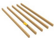
Установка лаг с шагом 305 мм. Пространство между лагами заполняется при необходимости тепло- и звукоизоляционными материалами. На лаги наносится монтажный клей.
