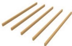
Установка лаг. Шаг лаг зависит от толщины плиты и назначения помещения. Пространство между лагами при необходимости заполняется тепло- и звукоизоляционными материалами.
