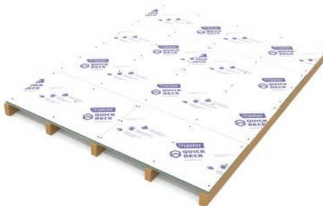
Укладка последующих плит выполняется со смещением швов. Не допускается образование перекрестных швов. При монтаже плита обязательно должна покрывать не менее 3-х лаг.
