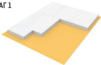
Укладка плит пенополистирола плотностью >25 кг/м<sup>3</sup> на сухое и выровненное основание. Штыки плит проклеиваются монтажным клеем.
