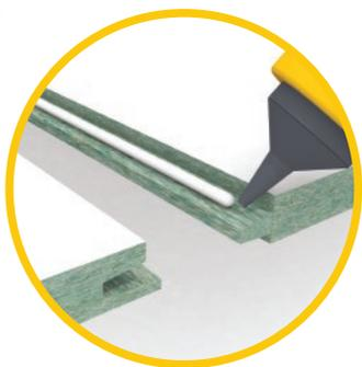
Штыки плит проклеиваются водостойким клеем ПВА D3 или D4.
